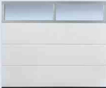
Für alle Tortypen und Nebentüren, mit Sicken-Optik, in den Oberflächen Woodgrain und Silkgrain®. Verglasungsrahmen: Aluminium-Rohrprofile in Naturton gebeizt (E6/EV1), auf Wunsch in Torfarbe. Verglasung: Je nach Tortyp als Einfach- oder Doppelscheiben aus Kunststoff, klar oder Kristallstruktur. Sonderverglasungen und Streckgitter auf Wunsch.
